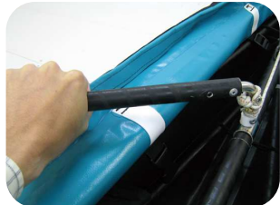
⑤スターン側フレームも取り付けウインチでテンションをかける
