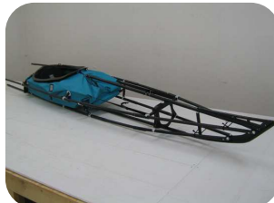
③バウ側フレームを取り付ける
