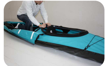
④船体布にフレームを押し込む
